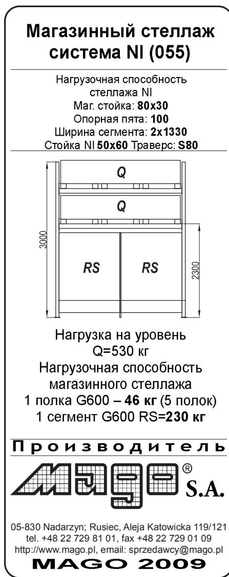
**Рис. 44.** Образцовый информационный щиток стеллажа
